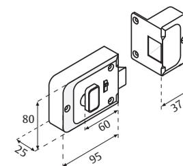
Cilindro ajustable hasta 2" de espesor de puerta
