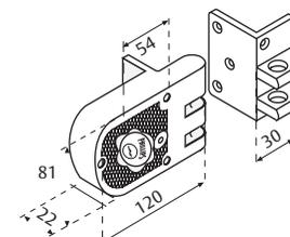
Cilindro ajustable hasta 2" de espesor de puerta
